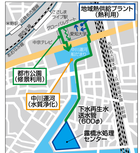
図3 下水再生水(高度処理水)の多目的利用
