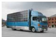
ソーラーパワートラック。 太陽光で発電される電気は、車両本体の動力としては使用しない。
