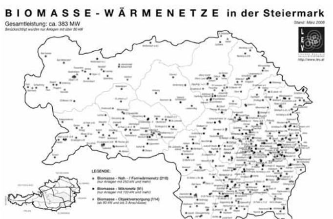
図2 オーストリア・シュタイヤマルク州のバイオマス地域熱供給施設(2008年)、250kW以上地域熱供給210カ所、100kW以上小型地域熱供給91カ所、単独供給114カ所 (資料:LandesEnergieVerein Steiermark)
