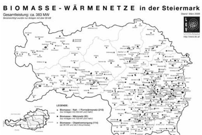
図2 オーストリア・シュタイヤマルク州のバイオマス地域熱供給施設(2008年)、250kW以上地域熱供給210カ所、100kW以上小型地域熱供給91カ所、単独供給114カ所
