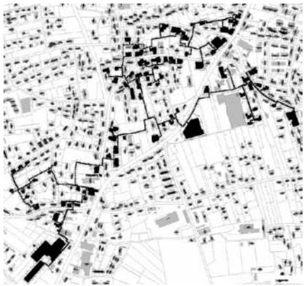
図3 ドルンビルンの地域熱供給、導管延長5.5km、チップボイラー2基合計出力1,800kW、需要家97件、導管込み建設費260万ユーロ(約3億円)、年間チップ使用量13,000m<sup>3</sup>
