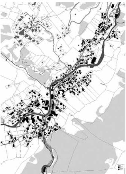
図4 レッピの地域熱供給、導管延長20km、チップボイラー3基合計出力15MW、需要家280件、導管込み建設費1,100万ユーロ(約11億円)、年間チップ使用量88,500m<sup>3</sup>、年間石油使用量10kl
